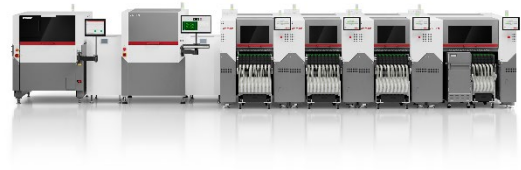
Mit integrierter Sensorik, Bildverarbeitung und automatisierten Qualitätsfunktionen liefern DEK TQ, Process Lens SPI und SIPLACE V die Voraussetzung für eine durchgängig qualitätsorientierte und intelligente SMT-Fertigung. (Bild: ASMPT)
