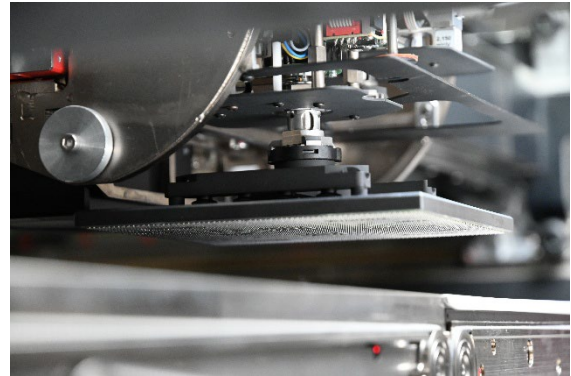
Bei großen Prozessor-BGAs entscheiden sichere Abholung, exakte Ausrichtung und die Koplanarität der Balls über die Qualität der späteren Lötverbindungen. (Bild: ASMPT)
