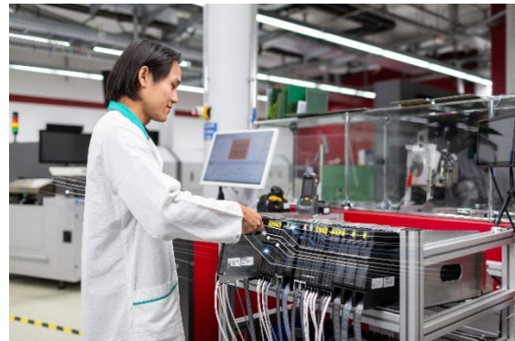
WORKS Logistics organisiert und optimiert die Zwischenlagerung von Material in einem Active Feeder Rack im Bereich der Rüstvorbereitung. (Bildquelle: ASMPT)
