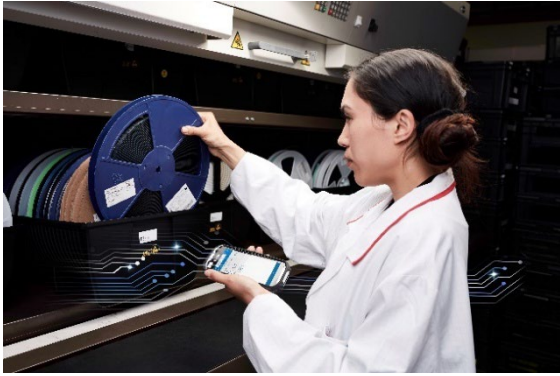
Die Mitarbeiter erhalten vom Factory Material Manager optimierte Kommissionierlisten auf ihre Handheld-Geräte und bestätigen die Entnahme durch Scannen der UID. (Bildquelle: ASMPT)
