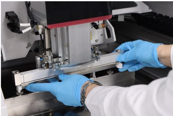
Die Rakel wird beim Herausfahren aus der Maschine automatisch entriegelt. Sie kann dann mit einem Handgriff gewechselt werden, bevor die Halterung beim Wiedereinfahren automatisch verriegelt. (Bild: ASMPT)
