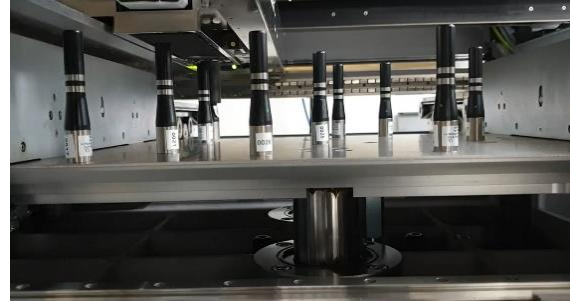
Die softwaregesteuert gesetzten Support-Pins kompensieren Leiterplattenverzüge und sichern eine reproduzierbare Druckqualität auch bei komplexen Layouts (Bild: ASMPT)
