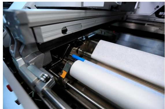
Hochgeschwindigkeits-Unterschablonenreinigung (USC) mit eigenen Linearantrieben: Bis zu 50 % schneller als konventionelle Systeme und dank 22 m Vliesrolle über eine komplette Schicht hinweg ohne Bedieneringriff einsatzbereit. (Bild: ASMPT)
