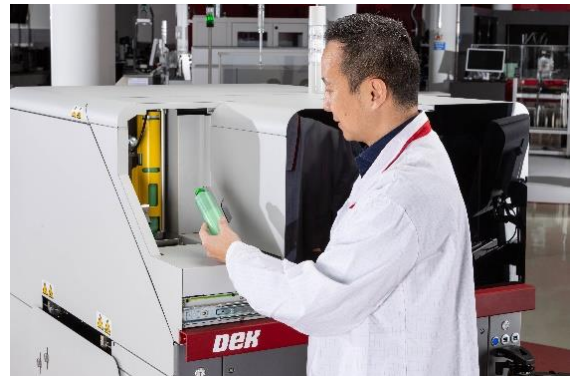
Das Dual-Access-Cover ermöglicht den Austausch der Lotpaste im laufenden Betrieb und trägt so zu höherer Anlagenverfügbarkeit und reduzierten Rüstzeiten bei. (Bild: ASMPT)
