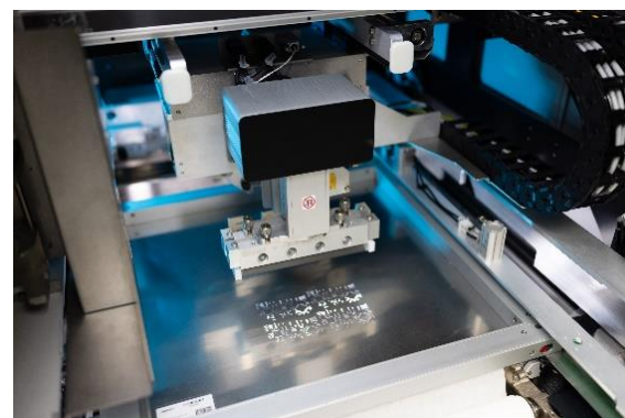
Die spannungsarm fixierte Schablone wird mit hoher Ausrichtungs-genauigkeit positioniert und schafft die Voraussetzung für stabile Pastenvolumina und prozesssicheren Druck. (Bild: ASMPT)
