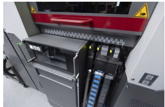
Kombination aus Tray Unit und per Feeder zugeführten Odd-Shaped-Komponenten: Die SIPLACE V Plattform bietet maximale Flexibilität für anspruchsvolle High-Mix-Fertigungen. (Bildquelle: ASMPT)
