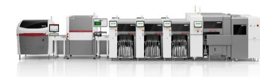
Durchgängige Highspeed-SiP-Produktionslinie: DEK Galaxy Lotpastendrukker gefolgt von dem Process Lens SPI-System und schnellen SIPLACE TX micron Bestückautomaten sowie der hybriden SIPLACE CA2 am Linienende, die zusätzlich Dies direkt vom Wafer bestückt. (Bildquelle: ASMPT)
