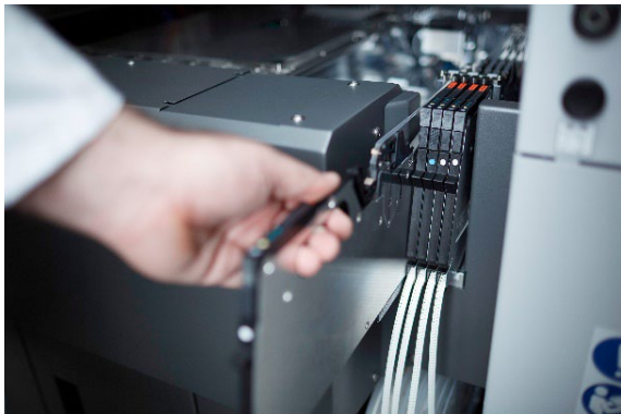
Per Feeder zugeführt, verarbeitet die SIPLACE CA2 auch klassische SMT-Bauelemente wie Widerstände, Kondensatoren, Transistoren und Dioden mit einer Geschwindigkeit von bis zu 76.000 cph. (Bildquelle: ASMPT)
