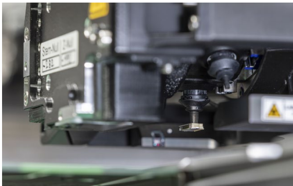
Der SIPLACE CPP ist der Allrounder für anspruchsvolle Mischbestückungen: Dank softwaregesteuertem Wechsel zwischen Collect-and-Place-, Pick-and-Place- und Mixed-Modus verarbeitet er bis zu 28.000 Bauelemente pro Stunde mit Bestückkräften bis 15 Newton. (Bildquelle: ASMPT)
